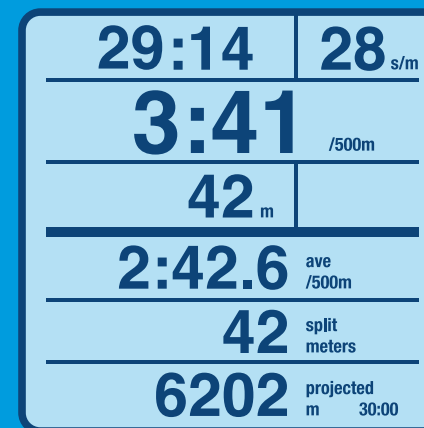
Le moniteur est programmé pour : un travail chronométré. La lecture du bas prédit la performance finale du rameur.
